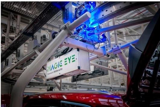
**Škoda Auto: Kamerasystem „Magic Eye“ erkennt frühzeitig Wartungsbedarf an der Fertigungslinie**
